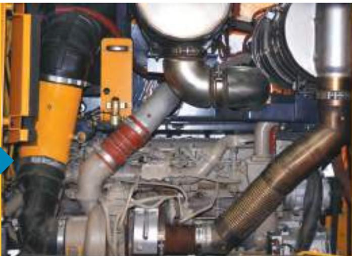
El confiable motor Cummins ofrece un sistema de combustible de conducto común de alta presión que garantiza un rendimiento eficiente al tiempo que la tecnología de tratamiento posterior, que incluye catalizador de oxidación, filtro de partículas diésel, reductor catalítico selectivo y un sistema de control e inyección de líquido de escape diésel (DEF, por sus siglas en inglés) AdBlue, hace que el motor funcione sin problemas.
