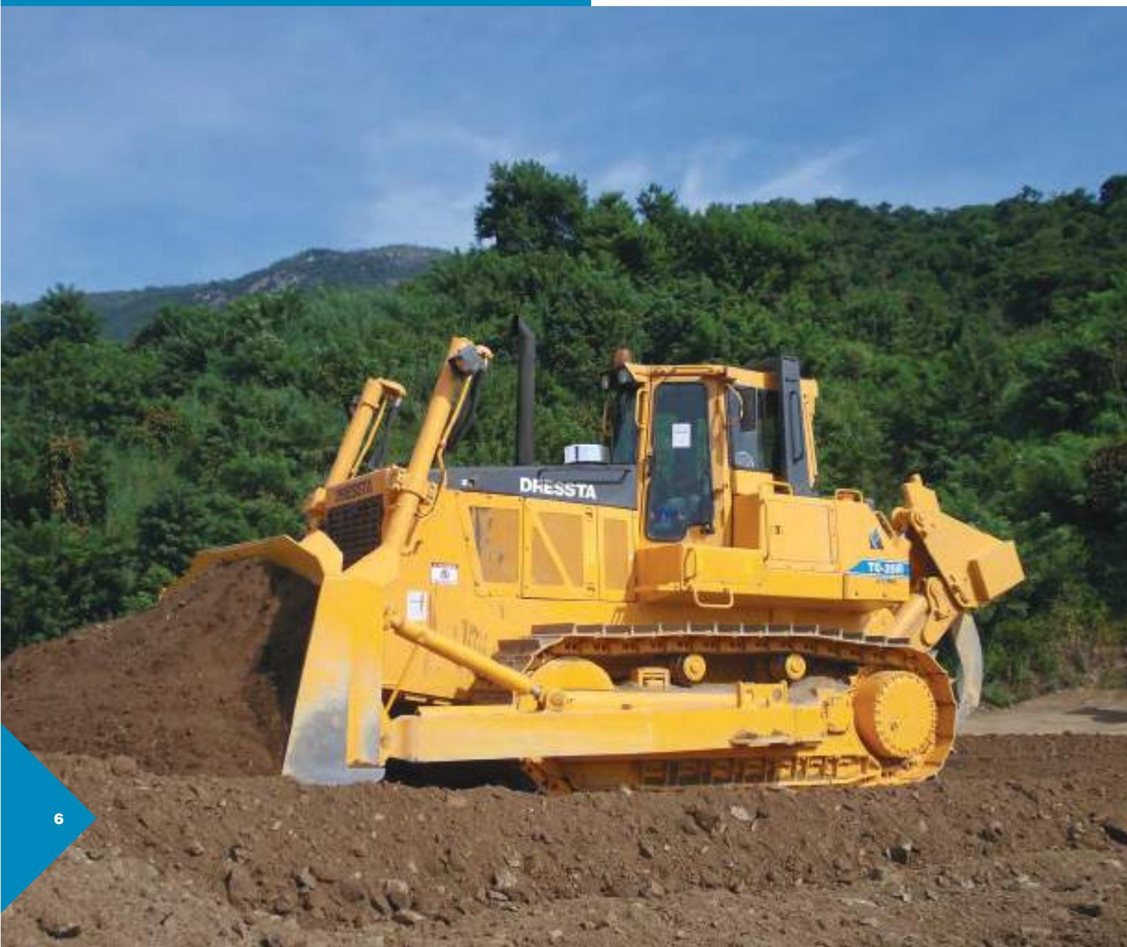
El bastidor masivo de una sola pieza, el eje de pivote de alta resistencia y el diseño de chasis exclusivo brindan máxima durabilidad y suspensión al tiempo que ofrecen al operador un desplazamiento continuo y estable.
